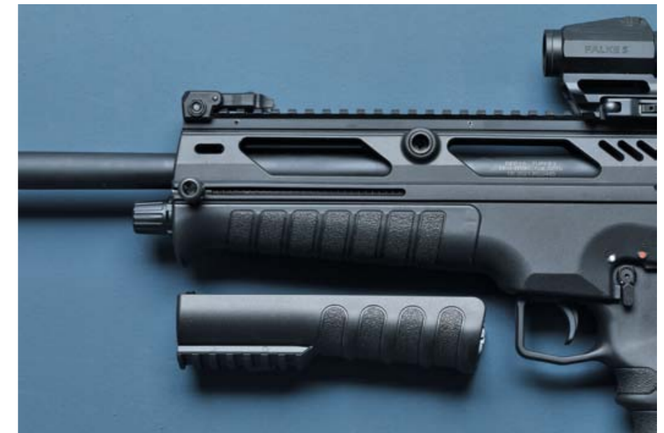
Blick auf die linke Waffenseite mit dem Ladehebel. Der Lieferumfang mit Wechselhandschutz mit kurzer Picatinny-Schiene an der Unterseite ist erfreulich umfangreich.
