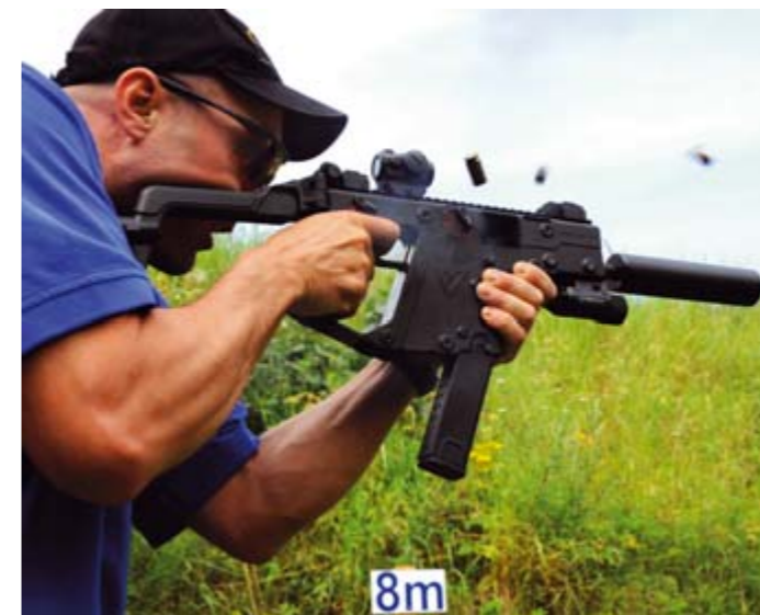
Kriss Arms stellte mit ihrer jungen Vector SMG eine Maschinenpistole mit interessantem Verschlusssystem den Spezialkräften vor. Die zurzeit nur in .45 ACP eingerichtete Waffe mit eigenwilligem Design soll demnächst auch in 9 mm Luger erhältlich sein.
