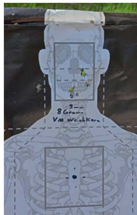
Diese Bilder zeigen die Abweichung, die das Geschoss beim Durchdringen der Windschutzscheibe erfährt. Während der schwarze Punkt im Brustbereich den Haltpunkt und den Durchschuss durch das Glas markiert, findet sich der Treffer weiter oben im Zielmedium wieder.
