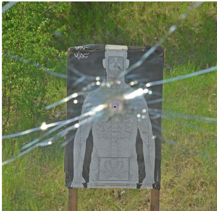
Diese Bilder zeigen die Abweichung, die das Geschoss beim Durchdringen der Windschutzscheibe erfährt. Während der schwarze Punkt im Brustbereich den Haltpunkt und den Durchschuss durch das Glas markiert, findet sich der Treffer weiter oben im Zielmedium wieder.
