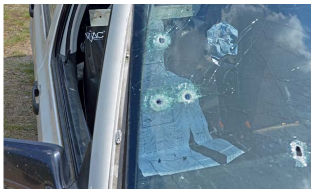
Bei auf Kurzdistancen von außen durch die Frontscheibe in den PKW-Innenraum abgefeuerten Schüssen sind Halte- und Treffpunkt nahezu identisch. Ebenfalls gut zu erkennen, die Glasstaubwolke, die ins Innere des Autos transportiert wird.
