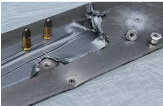
Wirkung der MEN 9 x 19 mm Armour Piercing im Vergleich zur Polizei-Einsatzpatrone auf Stahlplatte. Foto: JPW
