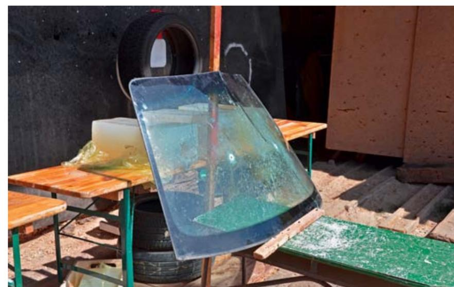
Grau ist alle Theorie: Deshalb gab es bei MEN einen Cockpit-Scheibenbeschuss eines A320/A330 mit Hartkernmunition in Kalibern von 5,56x45 bis 12,7x99 sowie bei Helmut Hofmann den Beschuss von ballistischer Seife nach dem Durchdringen von Autoglas mit der Hornady TAP in .223 Rem. und 7,62x51 sowie Critical Duty in 9 mm Luger.
